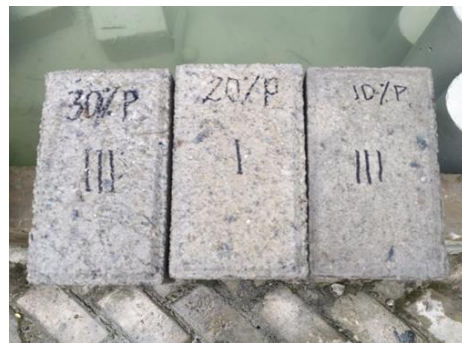
Gambar 9. Paving Block Menggunakan Limbah Plastik PP
