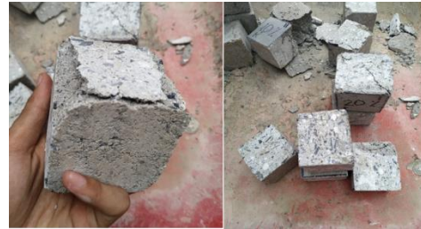
Gambar 6. Pola Retakan Paving Block
